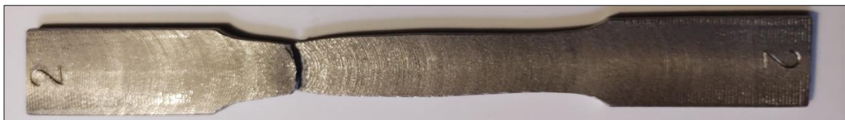
Obr. 9: Porušení ocelového zkušební tělesa 2 – v tahu za pokojové teploty.
